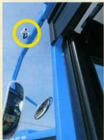
（上、右）バス側方の様子を捉えるカメラ。車両の左右に設置
