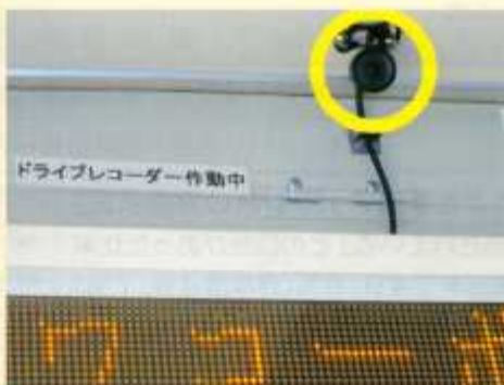
（左）車内の様子を捉えるカメラ。車内前方の表示板の上に設置
