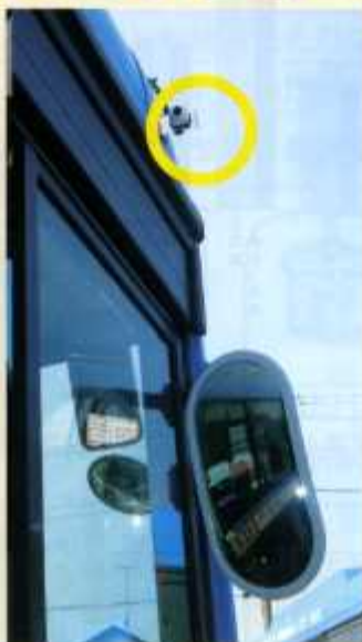
（上、右）バス側方の様子を捉えるカメラ。車両の左右に設置
