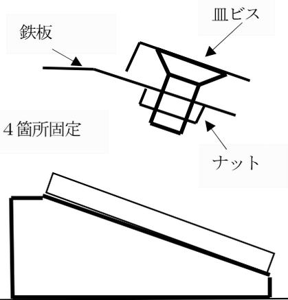
・パンフレット入れ固定方法について土台鉄板にナットを溶着し、皿ビスにより固定する。
