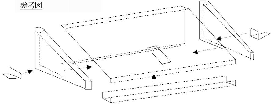
・車内燃料タンク部に鉄板を用い、参考図のパンフレット入れ取付土台を製作し取付する。
