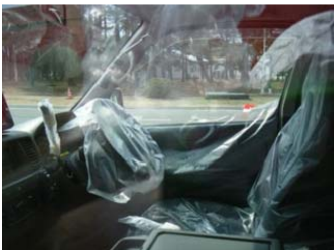
消防車内の汚染防止の養生
