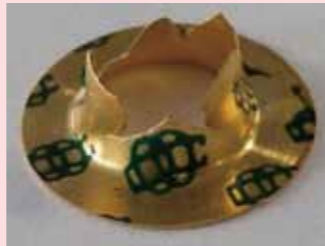
(破壊後の安全封板)
