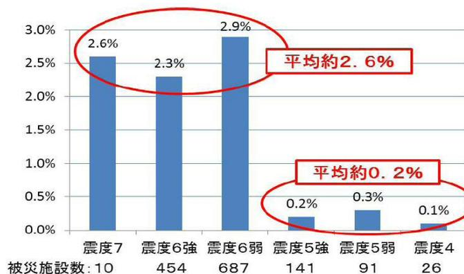
図2 地震による震度階級別被災率
