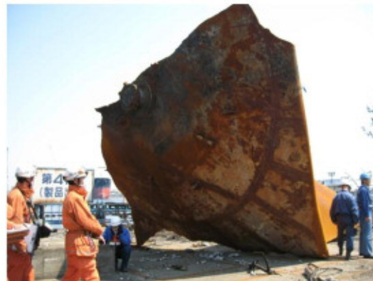
飛散したガスタンクの破片
