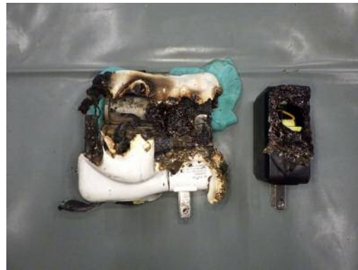
川崎市消防局で令和4年中に実際に発生したモバイルバッテリー火災の焼損状況
