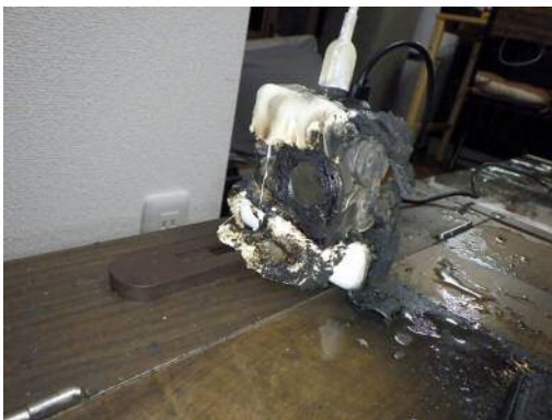
川崎市消防局で令和4年中に実際に発生したモバイルバッテリー火災の焼損状況
