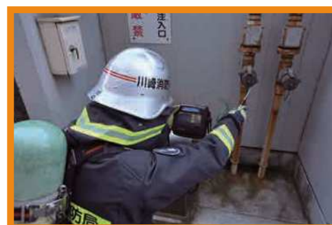
きかいをつかってガスもれをしらべる。
