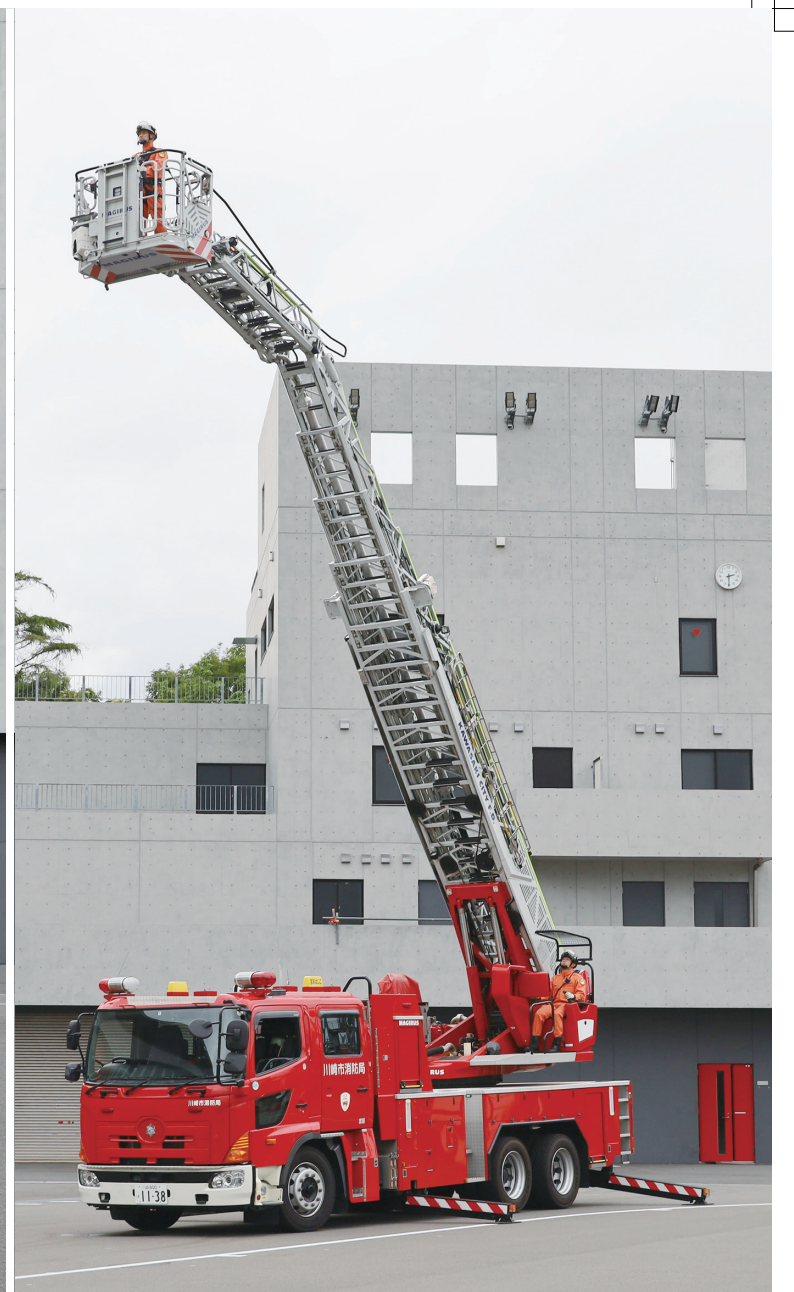
先端屈折式はしご車(宮前消防署) 撮影場所:川崎市消防訓練センター(主訓練塔前)
