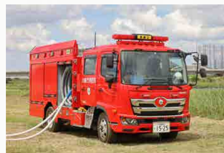
水槽付ポンプ車 11台
