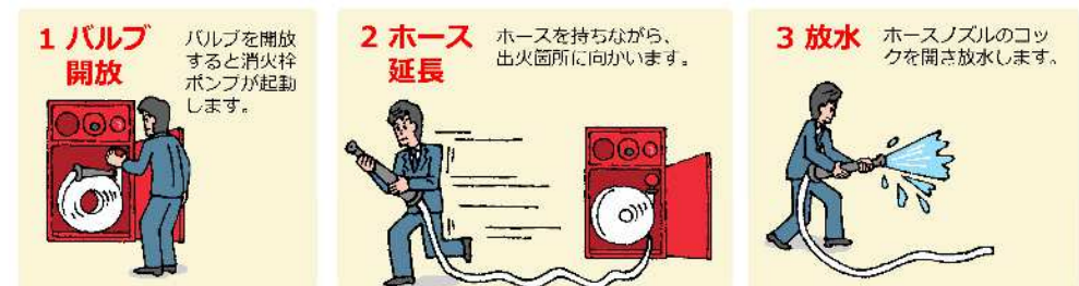
屋内消火栓設備（一人）の使用方法
