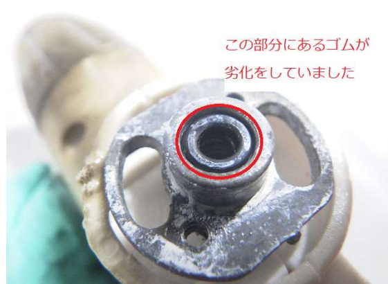
接続部分にあるゴムの劣化によって漏れたガスに引火した火災
