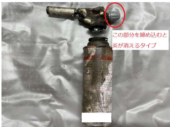
炎の消し方を把握していないことから発生した火災
