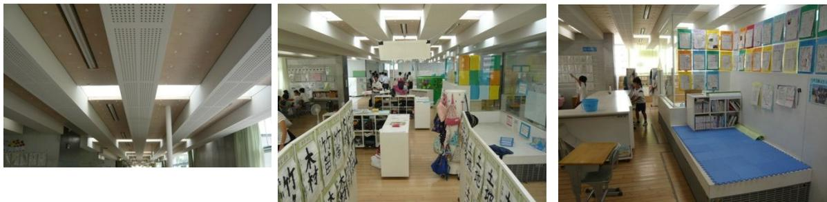
天井の吸音材、透明のガラスによる音の拡散防止
