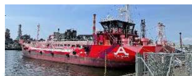
川崎港を拠点に運航している世界初のEVタンカー「あさひ」
