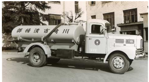
大型し尿処理用ヴァキュームポンプカー / 『清掃事業機械化処理器材アルバム』 （川崎市立図書館所蔵）
