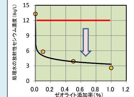
図3 凝集沈殿処理試験結果
