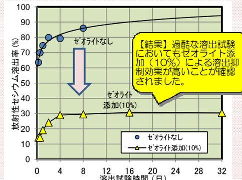
図2 長期溶出試験結果
