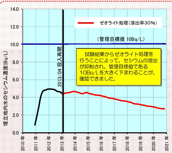
図5 埋立地内水のセシウム濃度シミュレーション値
