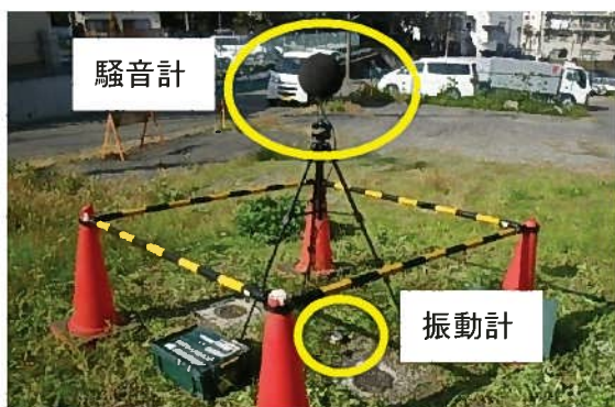
騒音・振動調査の例
