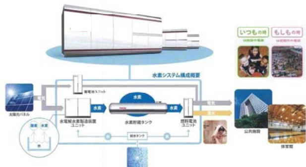
再生可能エネルギー由来の水素を用いた 自立型エネルギー供給システム
