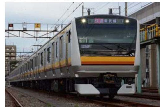
図 従来車両より定員が1割向上する幅広車両
