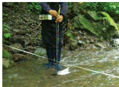
地表水の流量測定の例
