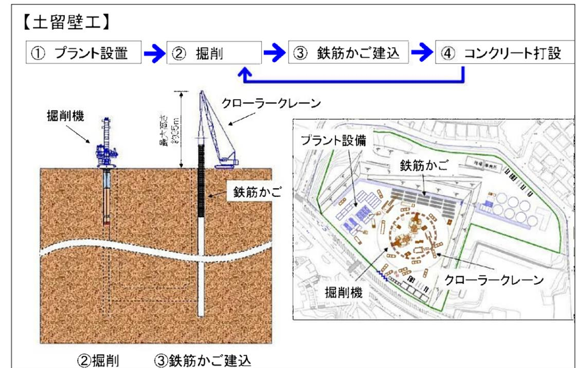
図 2-4(4) 土留壁工の施工位置及び手順
