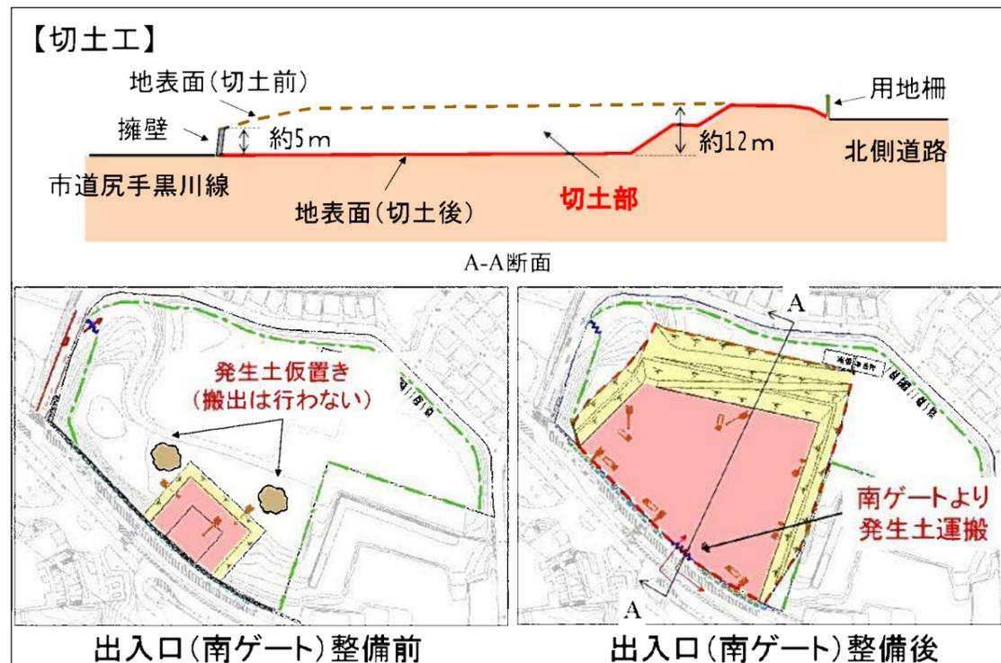
図 2-4(3) 切土工の施工位置及び手順
