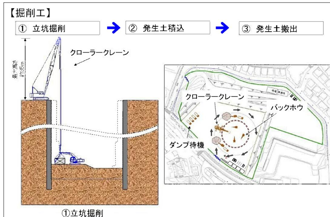
図 2-4(6) 掘削工の施工位置及び手順
