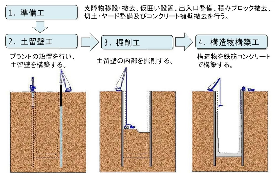
図 2-3 施工手順の概要
