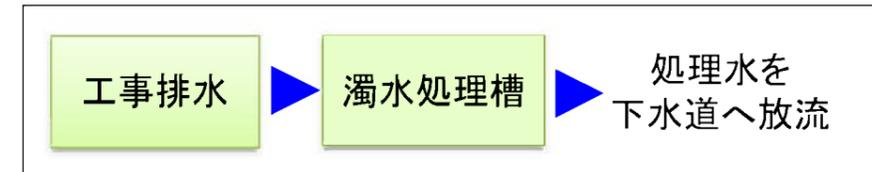
図 3-3 濁水処理のフロー図
