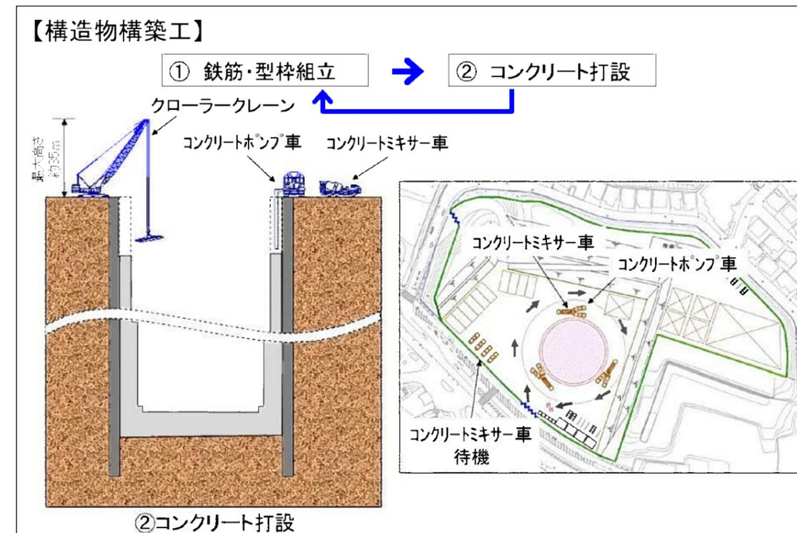
図 2-4(8) 構造物構築工の施工位置及び手順
