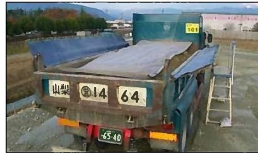
荷台への防じんシートの設置
