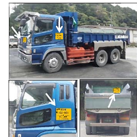
標識のダンプ明示状況
