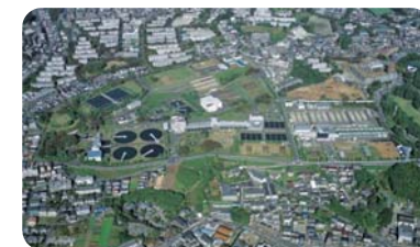
長沢浄水場 相模川を水源とし、昭和29年6月に通水を開始しました。また、再構築計画により浄水場全体を更新し、平成28年度から施設能力28万m 3 /日となりました。
