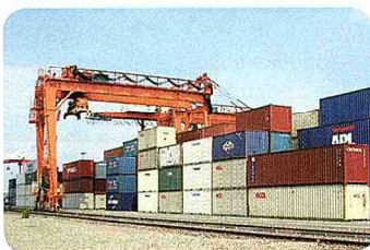
トランスファークレーン Transfer Crane
