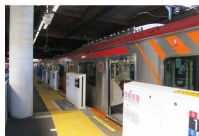
東急大井町線溝の口駅ホームドア
