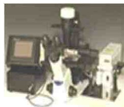
ヨダカ技研(株) (幸区) 遺伝子解析等で期待される、1細胞を正確かつ容易に抽出・連続搬送する装置を開発
