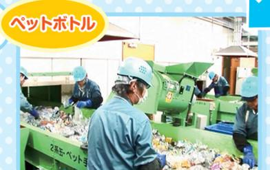
●分けられたペットボトルは手作業で不適物を除くほか、キャップを取り外します。
