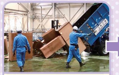
●集積所から収集車で収集した「小物金属」「粗大ごみ」はプラットホームに搬入します。
