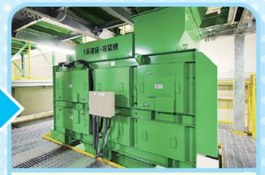
●機械でビニール袋を取り除き、磁石などの力でスチール缶アルミ缶とペットボトルに分けます。
