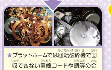
★プラットホームでは回転破砕機で回収できない電線コードや銅等の金属類を手で回収し、資源のリサイクルをしています。
