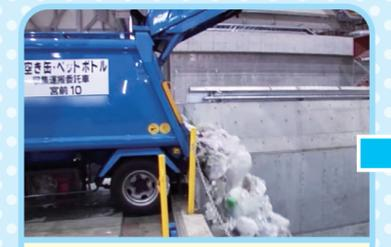
●集積所から収集車で収集した「空き缶」「ペットボトル」は受入ホッパに搬入します。
