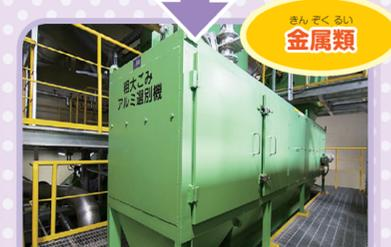
●粉々にしたものは選別機で「鉄」と「アルミ」を分けて回収します。残りは燃えるものとしてピットに運びます。
