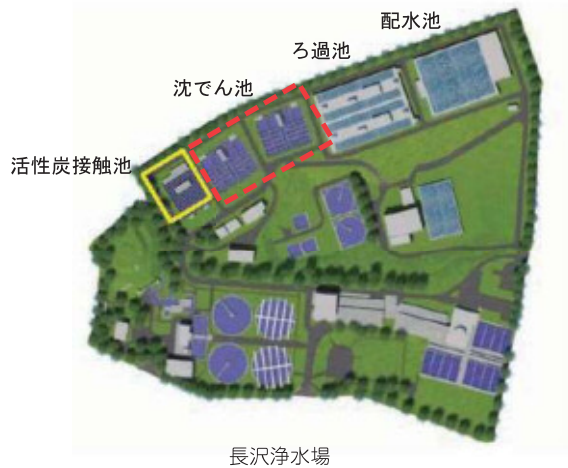
活性炭接触池(黄・実線)、沈でん池(赤・点線)(覆蓋設置前)
