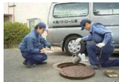
事業場排水採水状況
