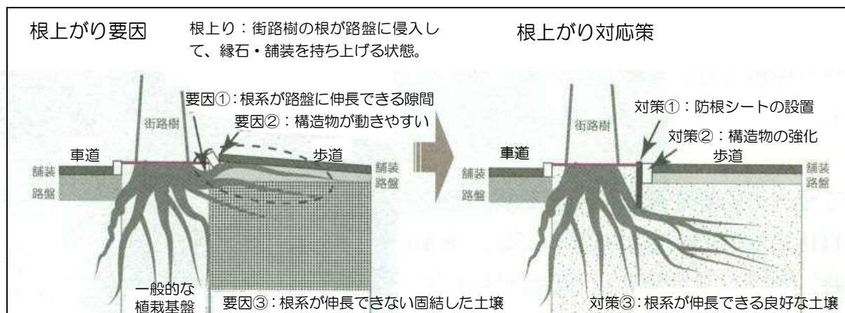
図-11 舗装面下の有効土層の確保等
