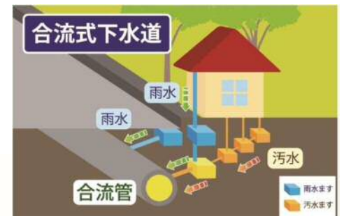
污水と雨水を1本の管で一緒に流す方法
