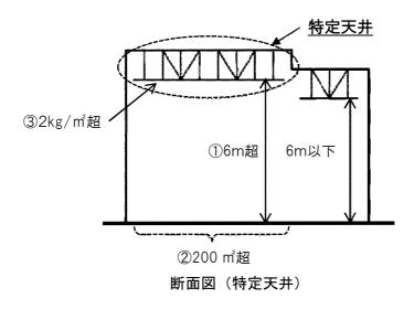
吊り天井とは、構造耐力上主要な部分等から天井面を吊り材により吊り下げる構造の天井
