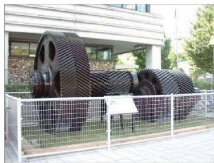
プラネタリー熱間圧延機フィードロール原則機用歯車
