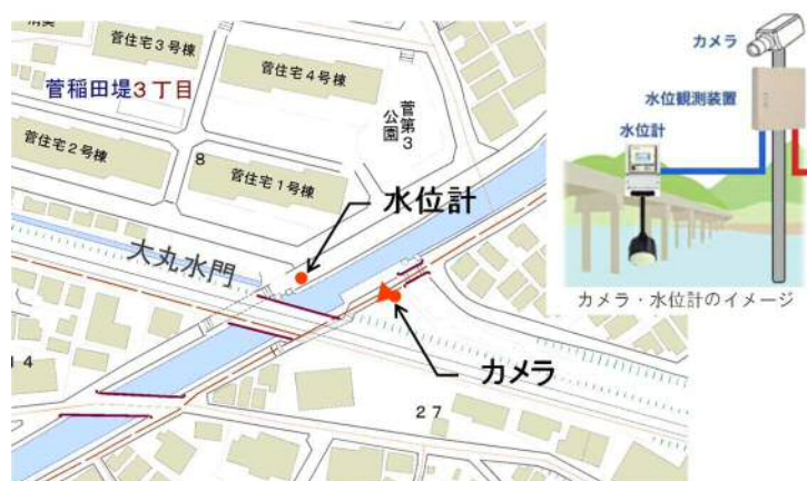
図 7-4-4 水位計、カメラの設置平面図
