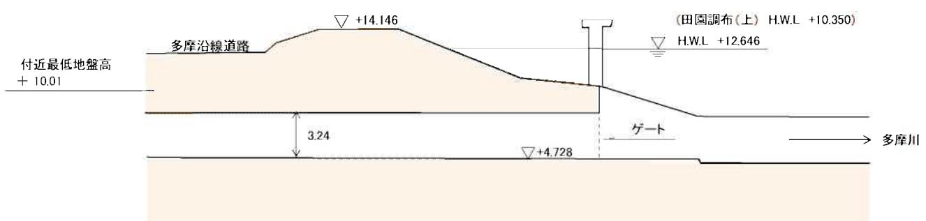
図 4-2-1 宮内排水樋管の概要と縦断面図
