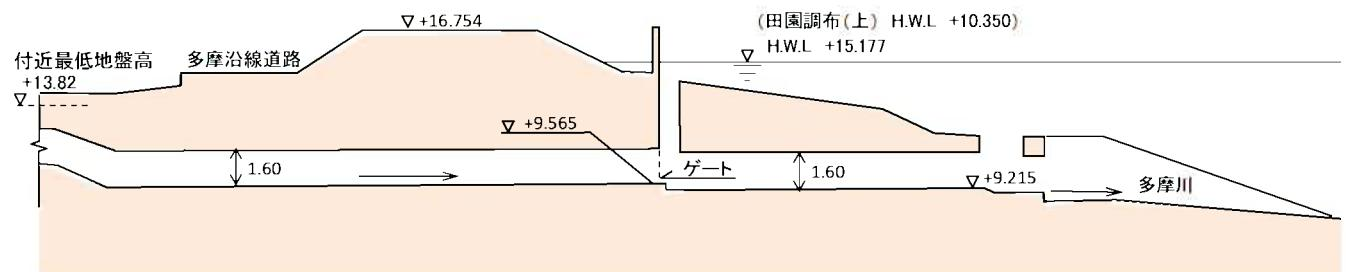
図 4-4-1 二子排水樋管の概要と縦断面図
