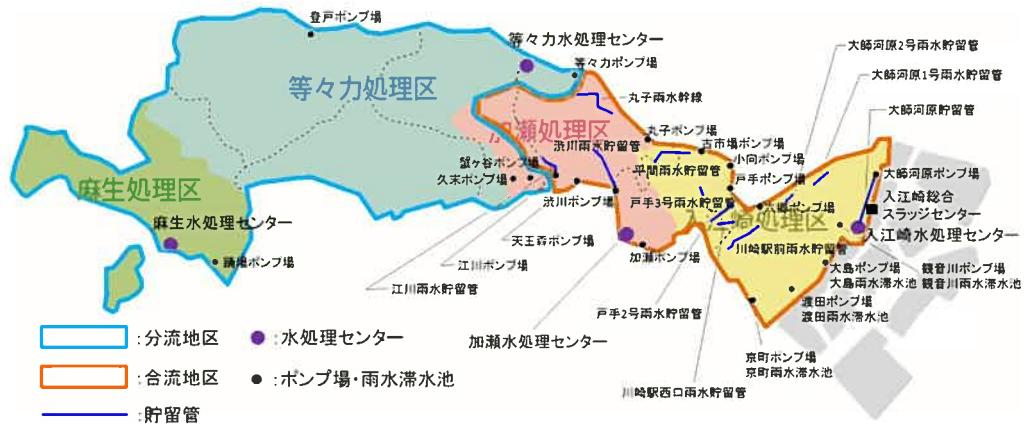
図 2-1 下水道（雨水）計画概念図
