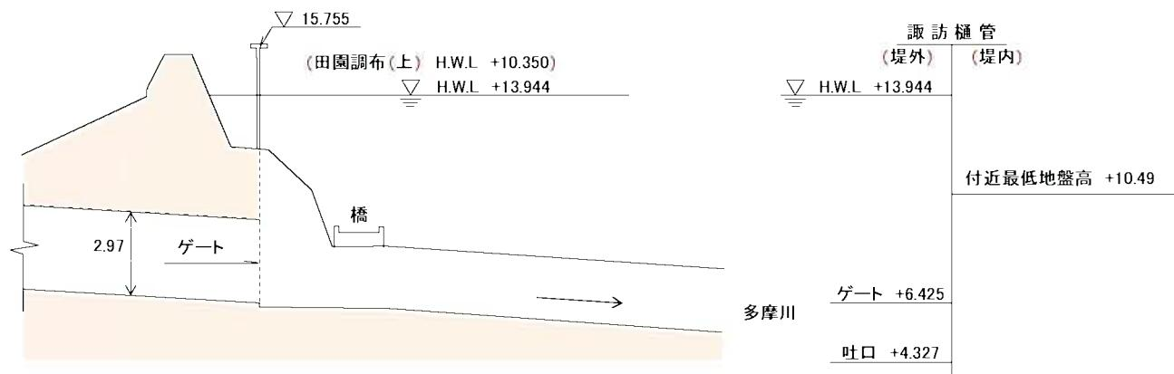
図 4-3-1 諏訪排水樋管の概要と縦断面図
