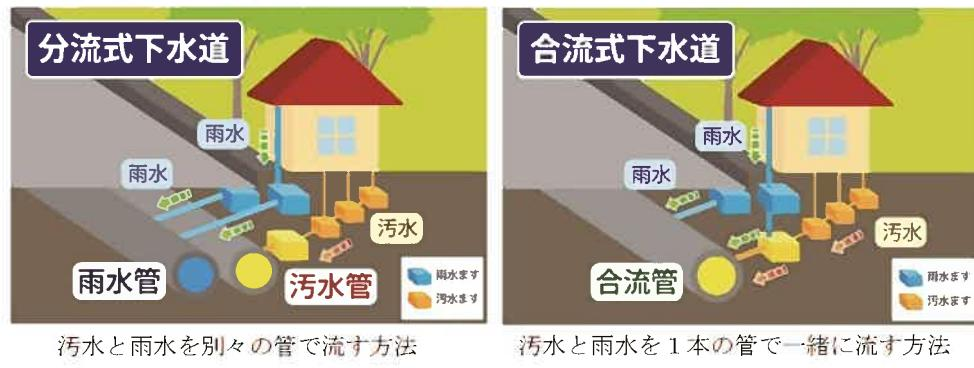
図3-1 下水道の排除方式
