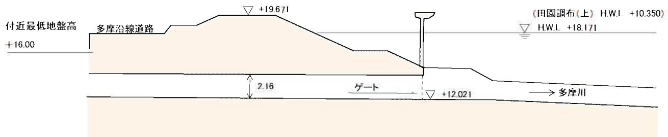
図 4-5-1 宇奈根排水樋管の概要と縦断面図
