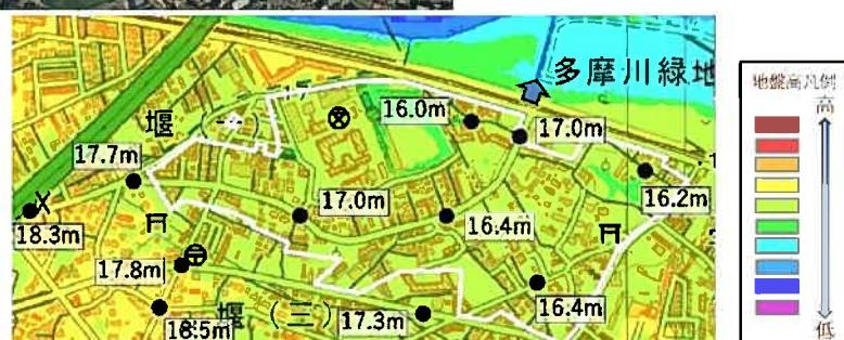
図 5-5-2 宇奈根排水樋管周辺の浸水発生区域と地盤高
