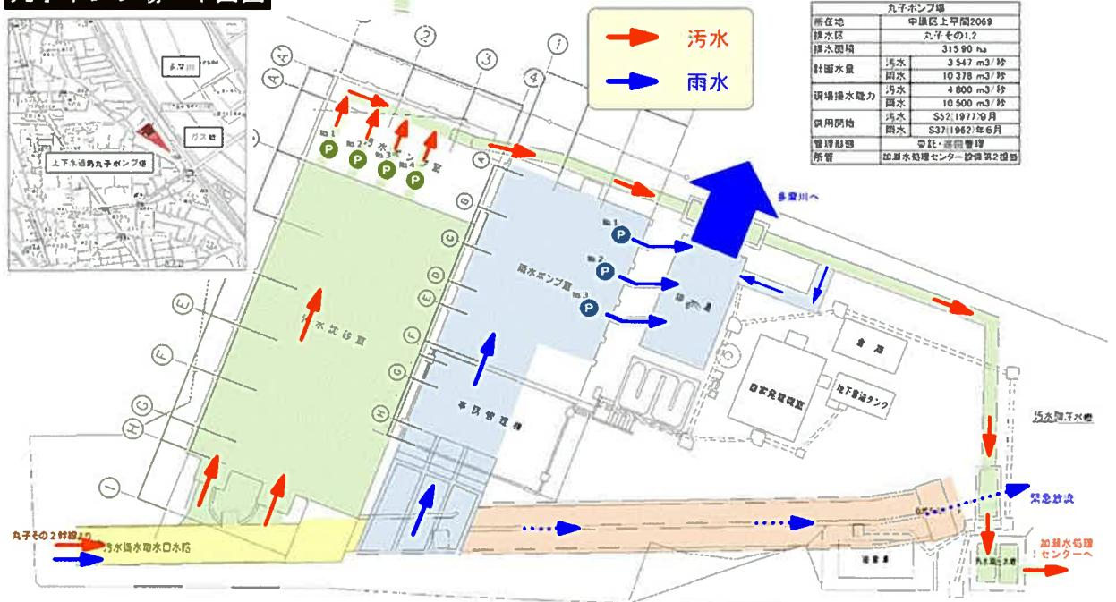
図 8-2-2 丸子ポンプ場平面図
