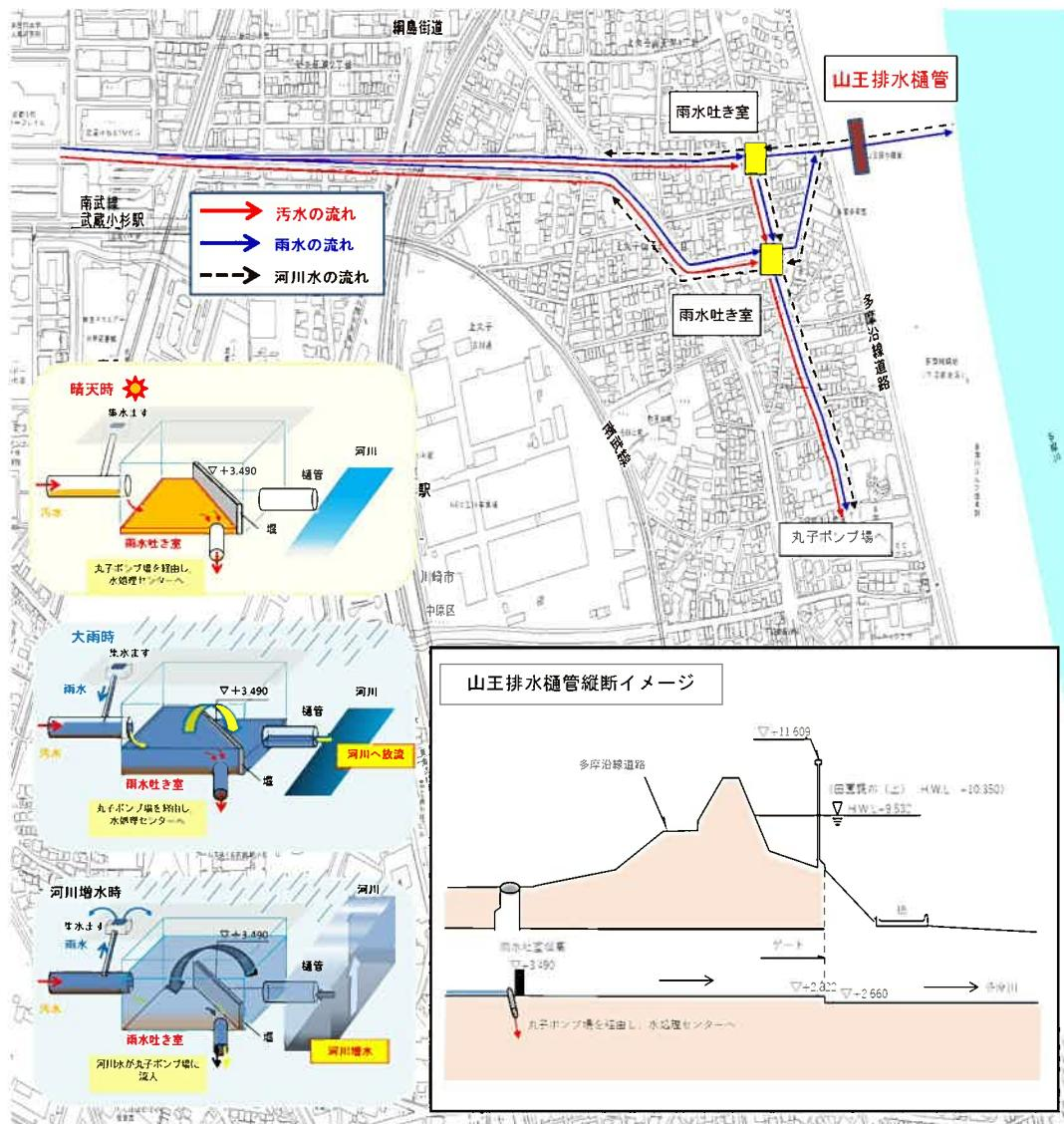
図 3-1-2 丸子その1排水区の雨水吐き室
