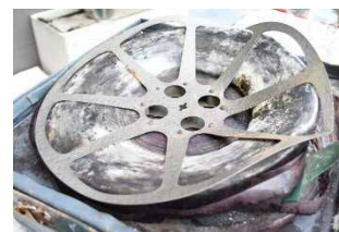
（写真4 カビが発生したフィルム）
