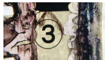
(写真3 乳剤が溶解したフィルム)
