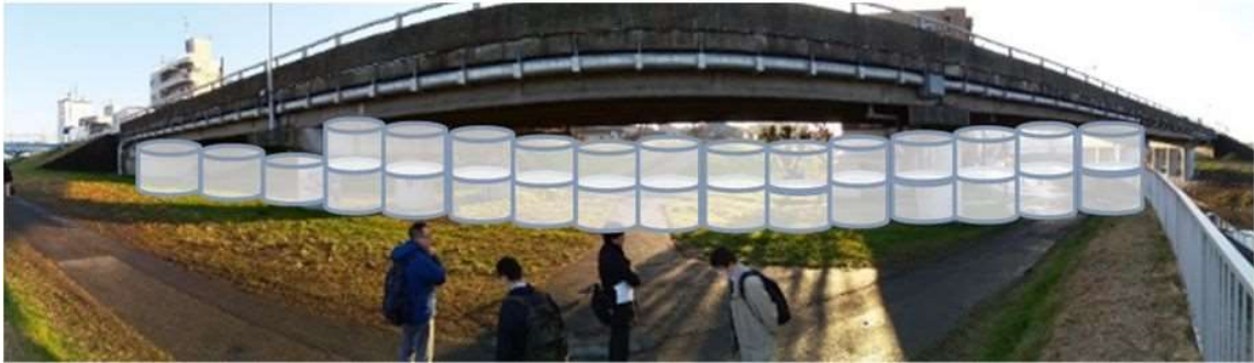
大型土のう設置イメージ
