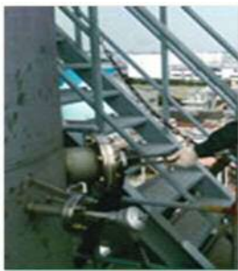
工場の立入によるばい煙測定
