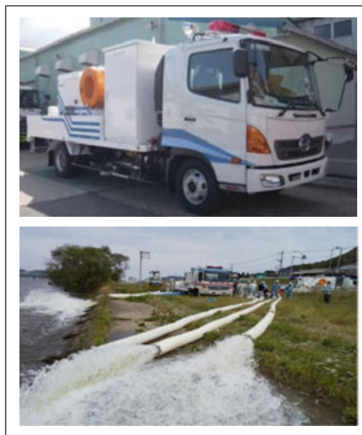
図 12-5-2 排水ポンプ車と対応イメージ
