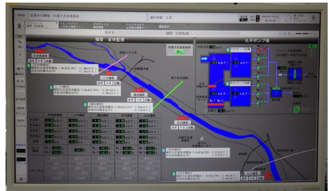
中央監視装置のモニター画面
