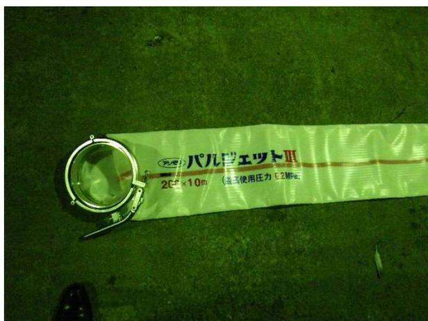
**注意：**ホースが接続部分の締め付けについては、水圧で外れることや漏水することがあるので、確実に締め付ける。また、接続面の汚れや異物は、漏水の原因となるため、接続前に清掃を行なう。
