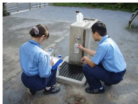
給水栓における水質管理
