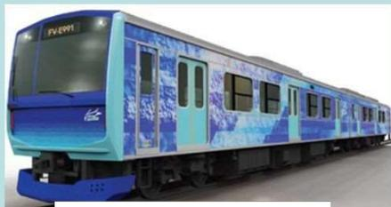
ハイブリッド車両(燃料電池)試験車両のイメージ図
