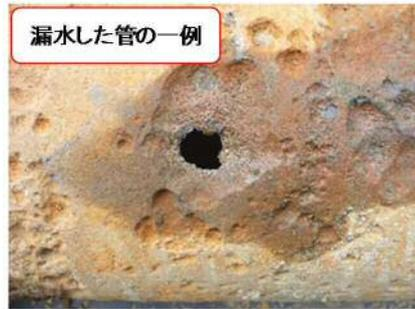
管路の老朽化が進行すると、腐食による穴、折損、ワレなどにより漏水が生じ、事故を引き起こす場合があります。管路の使用年数を抑制するよう、老朽化した管路の計画的な更新・耐震化を進めていきます。
