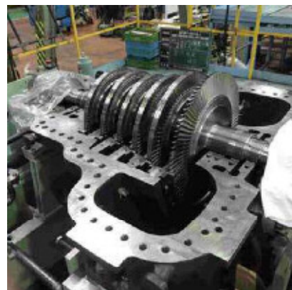
高効率蒸気タービン
