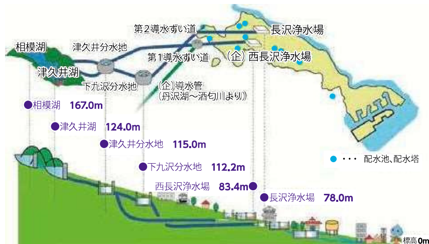
自然流下による水道システム
