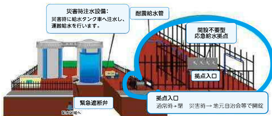
配水池・配水塔を利用した開設不要型応急給水拠点(災害時注水地点併設型)
