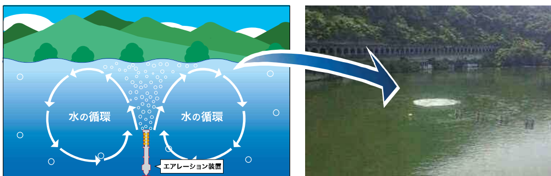
エアレーション装置
