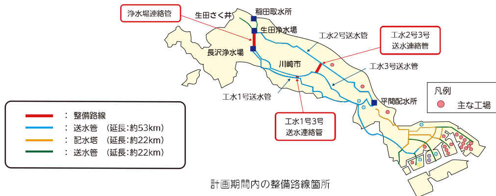
工業用水道基幹管路の二重化・ネットワーク化(イメージ図)
