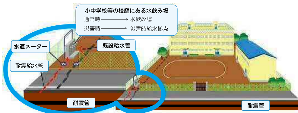
供給ルートの耐震化が完了した市立小中学校の開設不要型応急給水拠点(既設給水栓利用型)
