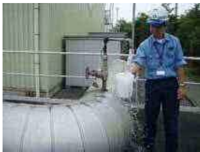
定期工業用水試験採水作業
