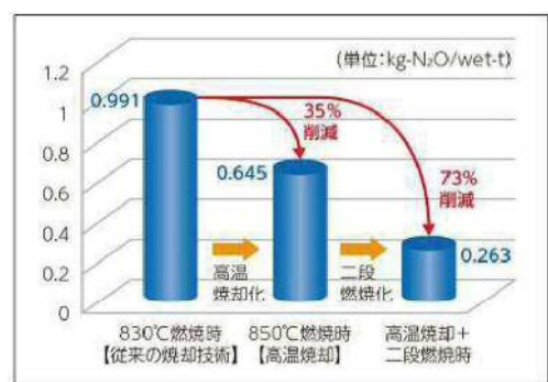
二段燃焼化の効果 【焼却する汚泥(脱水汚泥)1tあたりの N_2O 排出量の比較】
