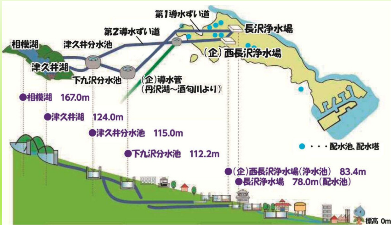
自然流下による水道システム
