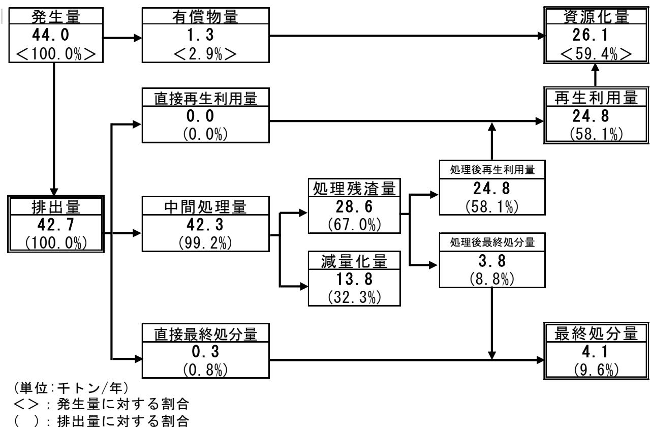
図8 廃プラスチック類の処理フロー（令和元(2019)年度実績）
