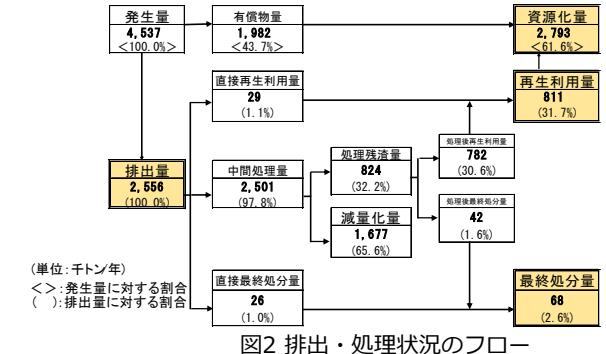
図2 排出・処理状況のフロー
