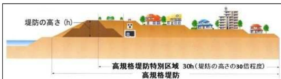
図 14.32 高規格堤防の概略図（国土交通省京浜河川事務所HPより）
